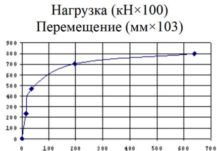
Рисунок 2 – Деформации узла сопряжения подкоса со стойкой
