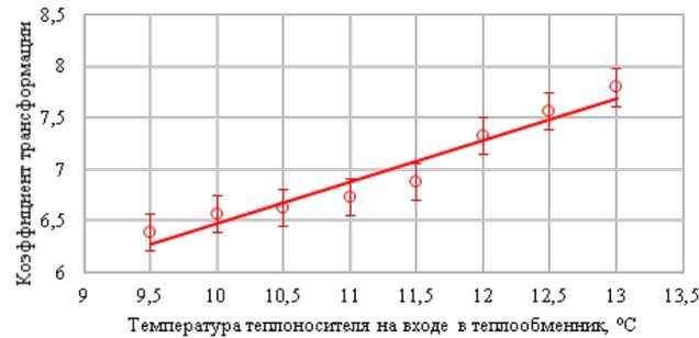
Рисунок 6 – Зависимость коэффициента трансформации от температуры теплоносителя
