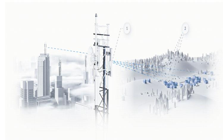
Рисунок 2 – Конфигурация беспроводной сети с объединением сегментов локальной сети и удаленных на большие расстояния антенн.
